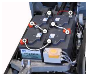
Esboço de montagem para 4 baterias
