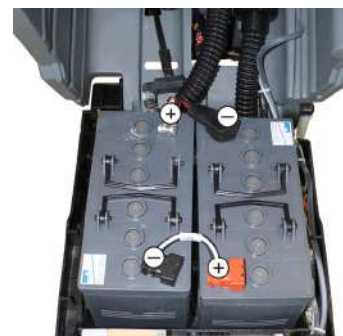
Esboço de montagem para 2 baterias
