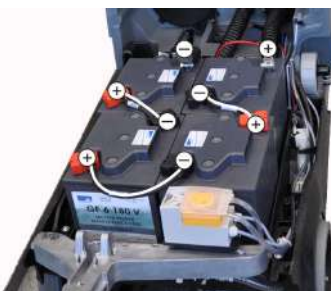
Shēma 4 akumulatoru iebūvēšanai
