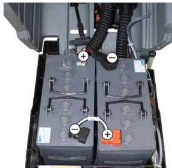
Shēma 2 akumulatoru iebūvēšanai
