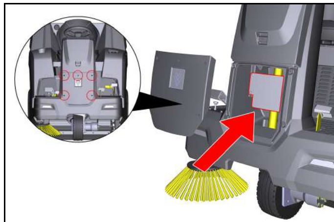
A: Varovalke na elektronskem krmiljenju
